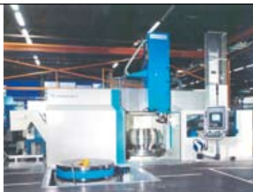
DST Dörries karusell dreiesenter med palet- tering for dreining, boring og fresing
