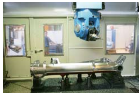
Droop&Rein maskin type FOGD40 maskin med landings-understell for hjuloppheng for større sivile fly.
