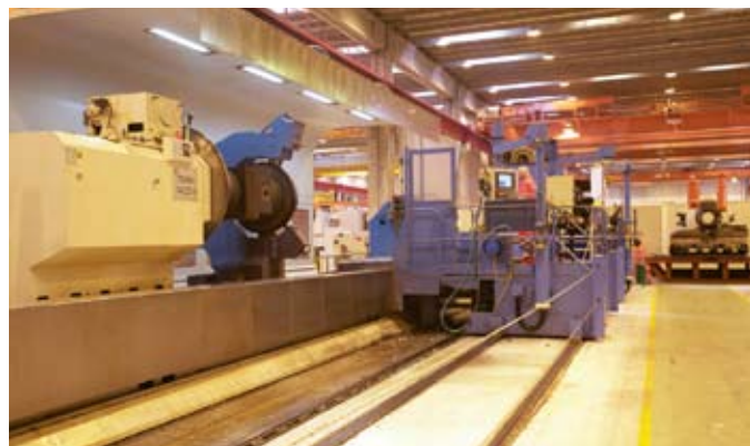
Tacchi dreie- bore og fresesenter for komplettbearbeiding. Levert til Aker Solutions Tranby.
