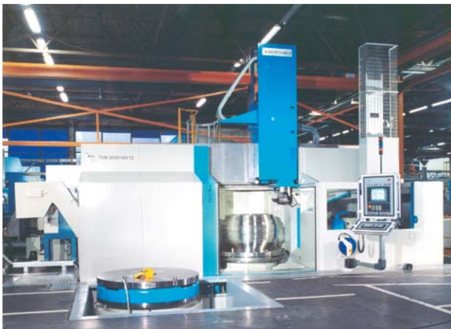
DST Dörries karusell dreiesenter med pallettering for dreining, boring og fresing
